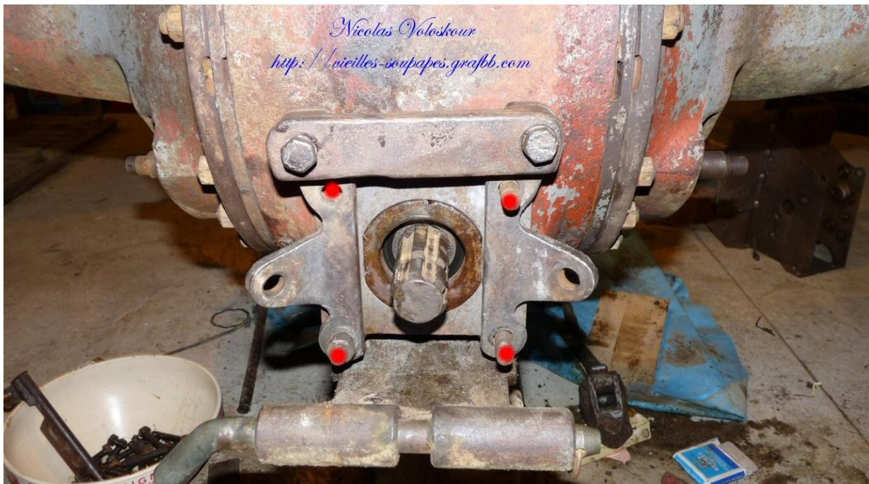
Retirez les 2 vis 6 pans de la plaque qui retient la pièce de centrage et d'é-tanchéité de la prise de force.
