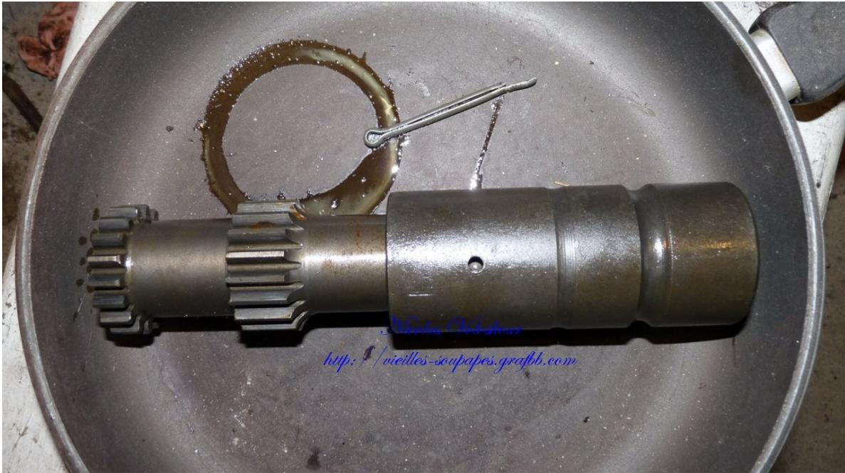
La pompe hydraulique est prise en sandwich entre l'arbre moteur venant de la boîte et la prise de force arrière, il faut retirer celle-ci pour sortir la pompe.
