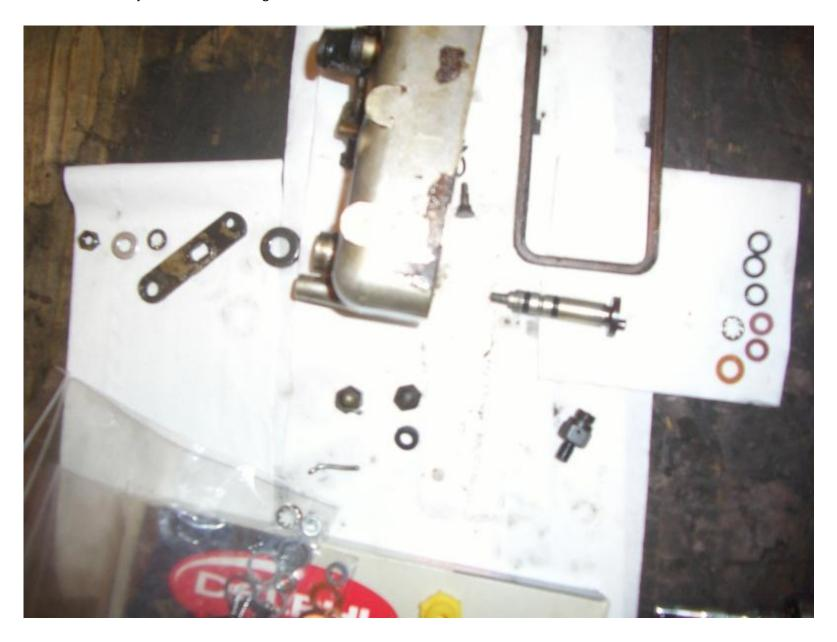
Pose d'un joint neuf de couvercle.
